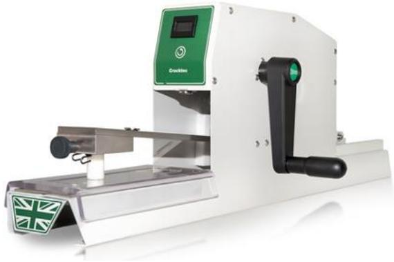
Das klassische Design des *CROCKMETERS* wurde unter Verwendung fortschrittlicher Materialien verbessert, um die Reibung am Kurbelzapfen und Führungsarm zu minimieren und gleichzeitig den Bedarf an Ölung und das Potenzial der Kontaminierung zu beseitigen.
