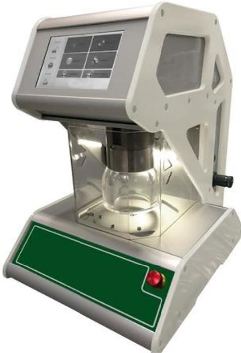
Das Berstdruck-Prüfgerät ist ein Druckluft-Messgerät, das den erforderlichen Druck zum Zerbersten von Proben und die Dehnung vor dem Zerbersten misst. Die Dehnungshöhe der Probe wird mittels Lasertechnologie gemessen. Alle Berstproben werden nach den internationalen Hauptstandards ausgeführt. Diese sind bereits eingestellt oder können frei programmiert werden, um sich den individuellen/kundenspezifischen Einstellungen anzupassen.
