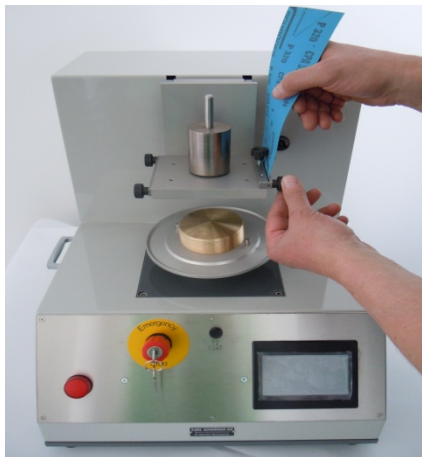
Schritt 1: Schmirgelpapier in Einspannvorrichtung einlegen.
