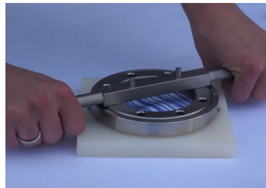
Schritt 6: Ziehen Sie den inneren Spannung mit dem Schraubenschlüssel
