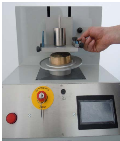
Schritt 5: Einspannvorrichtung mit dem Schmirgelpapier vorsichtig auf die Probe setzen
