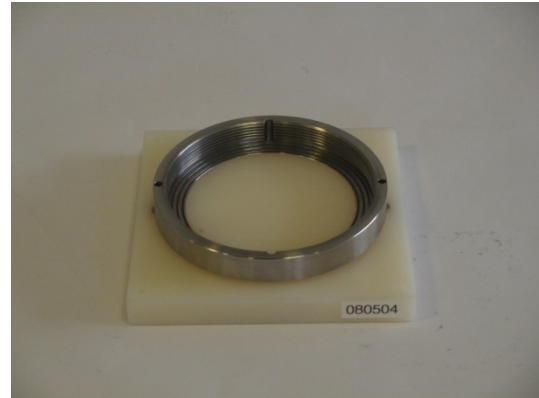
Schritt 2: Äußeren Spannung auf die Grundplatte legen.
