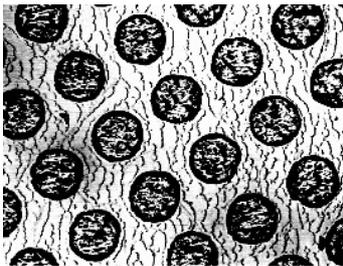
Abriebbild einer verschromten Ballardhaut nach 2 Mill. Umdrehungen
