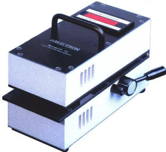
Die Luftdurchlässigkeit wird mit dem Gerät im Handumdrehen ermittelt. Nach Einlegen der Probe und Umlegen des Handhebels wird innerhalb von 3 sec der Messwert digital angezeigt.
