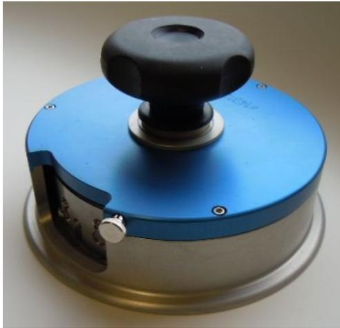
Nur ein Prüfling mit genau eingehaltenem Flächenmaß garantiert die zuverlässige Gewichtsbestimmung. Deshalb baut SCHRÖDER für Sie die Probenschneider PS. Scharfe, kreisförmig geführte Messer erzielen im ziehenden Schnitt maßgerechte Rundproben mit absolut glatten Rändern. Selbst "kritische" Materialien wie dünne Folien, Seidenpapier, Wellpappe, Strumpfgewirke, Vliesstoffe, Teppiche, Kunstleder, flauschige oder samtartige Gewebe lassen sich problemlos schneiden.
