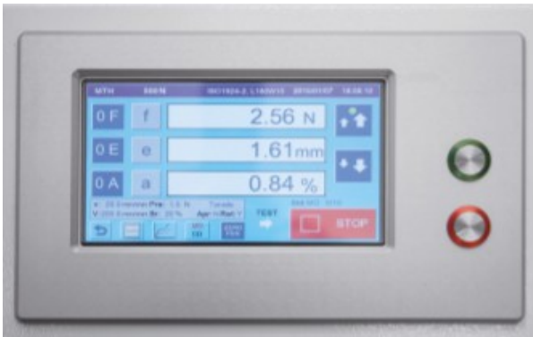
Abb.3: Display des Dehnungstesters mit zwei separaten Start- und Stopp-Tasten.
