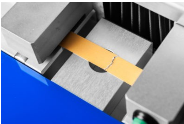
Abb.2: Wasserbad für nasse Messungen. Messungen für bis zu 50 mm breite Streifen möglich. Der Dehnungsbereich reicht von 50 mm bis 180 mm Abstand zwischen den Klemmen.
