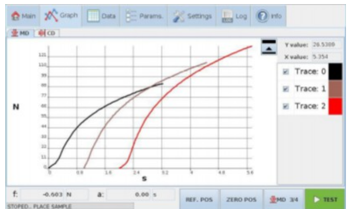
Abb.4: Das Gerät ermöglicht es, Tests voreinzustellen, die Testparameter zu konfigurieren und die Testergebnisse, grafische Kurven, erzeugte Testberichte, etc. zu speichern.
