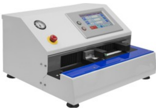
Abb.3: Display des Dehnungstesters mit zwei separaten Start- und Stopp-Tasten.
