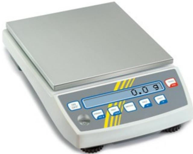
Frei programmierbare Wägeeinheit, z. B. Papiergewicht  $\text{g/m}^2$ , Anzeige direkt in Fadenlänge  $\text{g/m}$ , o. ä.
